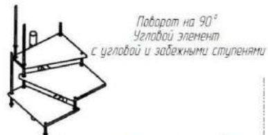
Схема расположения ступеней относительно опорных площадок металлического каркаса
